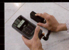
物の表面から反射する光沢度を簡単操作でリアルタイムに表示
